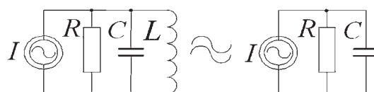
Ryc. 1. Uproszczony schemat zastępczy komórki [3]
